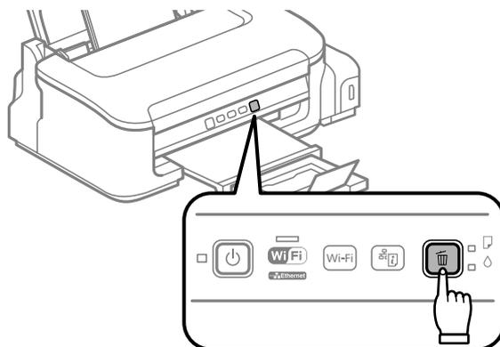
Устройство начнет прочистку печатающей головки.
