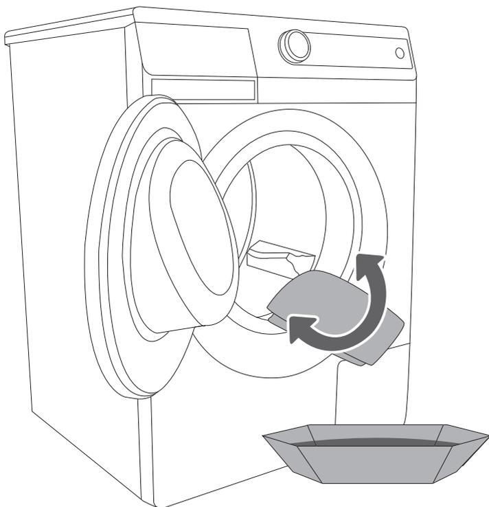
Перед первым использованием стиральной машины очистите барабан влажной тряпкой с добавлением мягкого мощного средства или включите программу *Самоочистка*.
