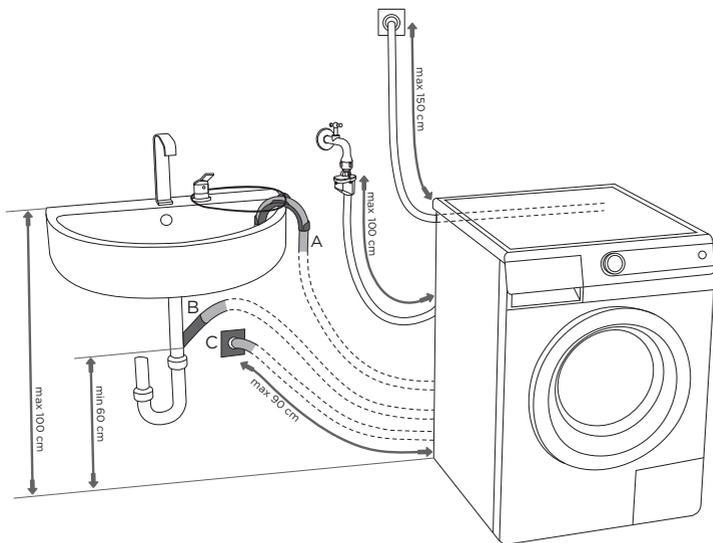
**А** Сливной шланг можно закрепить на раковине или ванне. При помощи шнура, протянутого через пластмассовый кронштейн, закрепите сливной шланг таким образом, чтобы он не соскользнул на пол.
