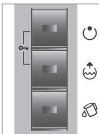
Дополнительные функции включаются и выключаются нажатием на соответствующую кнопку (до нажатия на кнопку СТАРТ/ПАУЗА). Некоторые функции для отдельных программ невозможно установить, о чем предупреждает звуковой сигнал и мигающая лампочка-индикатор (см. таблицу программ).
