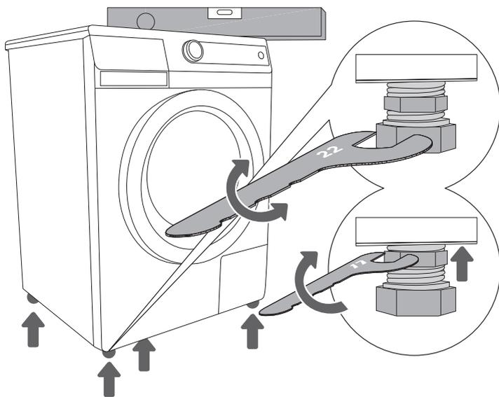
**1** Выровняйте прибор по горизонтали и по вертикали, вращая регулируемые ножки, которые позволяют выровнять прибор на  $\pm 1$  сантиметр.
