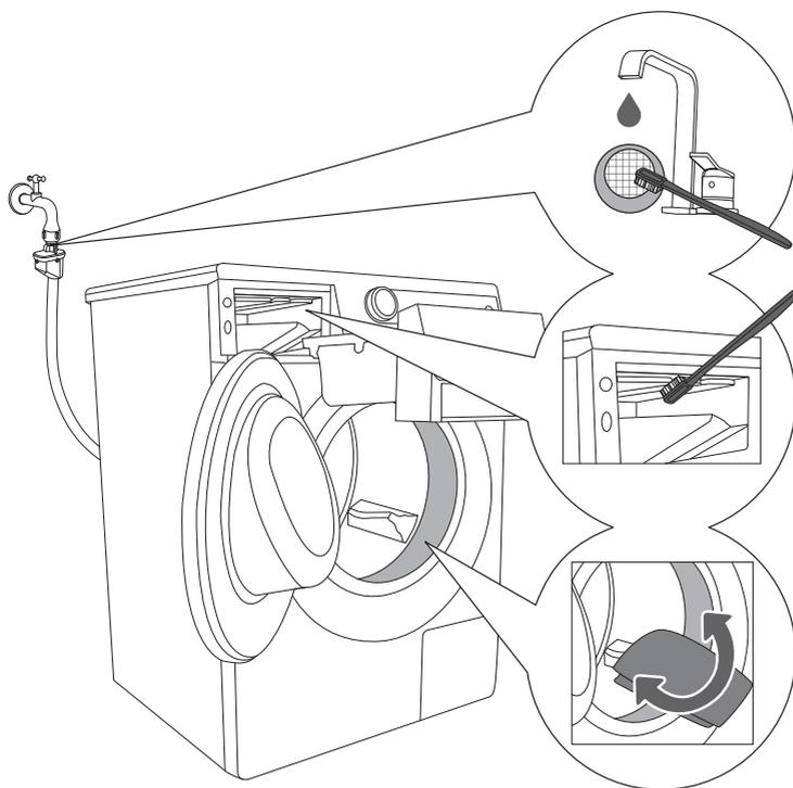
**1** Регулярно промывайте фильтр заливного шланга под проточной водой.
