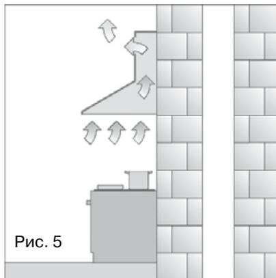
В этом режиме на вытяжку должны быть установлены угольные одноразовые запахоулавливающие фильтры. Эти фильтры не входят в комплект вытяжки и приобретаются отдельно. Использование вытяжки в режиме рециркуляции снижает ее производительность.
